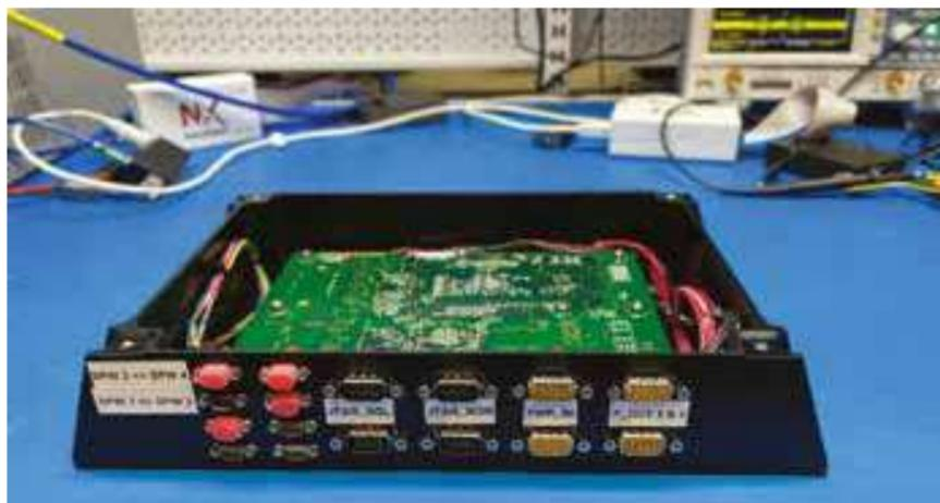
El sistema de aviónica espacial está compuesto por dos cámaras de navegación y un coprocesador redundado para procesamiento de imágenes (IPB) altamente versátil que podría utilizarse para operaciones de encuentro y búsqueda de satélites,
