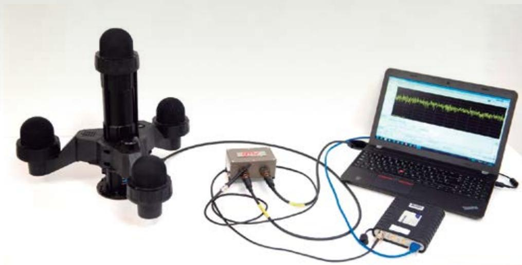
*Detector de Disparos PILAR V junto con los elementos desarrollados por GMV en pruebas de integración*
