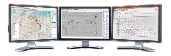
As interfaces inovadoras da **SAE-R**® dispõem de diferentes pontos de vista para representar comboios e estações em tempo real (ou seja, GIS, sinótica clássica, vista sinótica vertical). Cada vista implementa ferramentas gráficas específicas para gerir os seus elementos.
