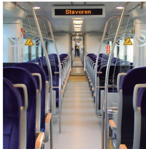
La información de la estación actual y la siguiente se muestra en letreros a bordo y / o monitores a bordo. El audio se transmite simultáneamente a través del sistema de megafonía del tren.
